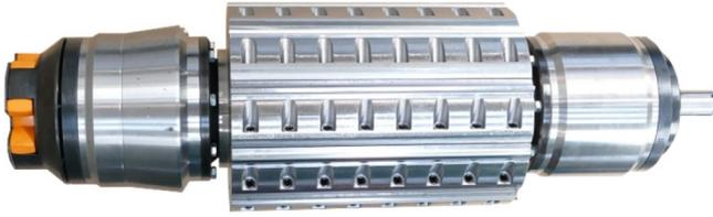
Die Wellen können durch einen motorisierten Antrieb aus der Maschine gefahren werden und sind zusammen mit ihrer Lagerung leicht, sicher und schnell austauschbar.
