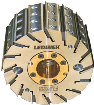
Eine bronzene Hydrobüchse ist weicher als die hartverchromte Stahlspindel. Dies sorgt für eine sanfte Montage und verhindert eine Beschädigung der Spindel auch beim Verdrehen.
