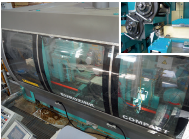
Diese Ledinek-Eurozink Compact bei Kirnbauer hat eine Leistung von sechs Takten pro Minute – in einem Durchgang wird gefräst, beleimt und verpresst
