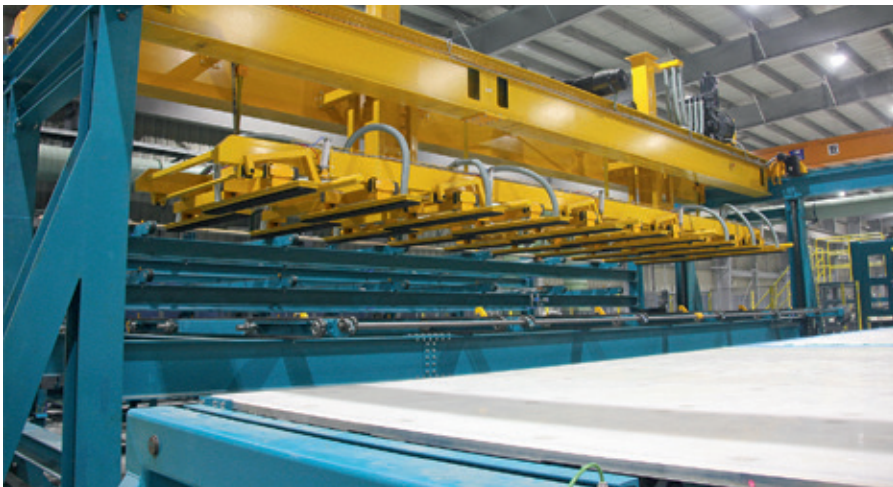
Doppelvakuum-Entstapelung zur Vorbereitung der Lagen vor der 12 m-Press
