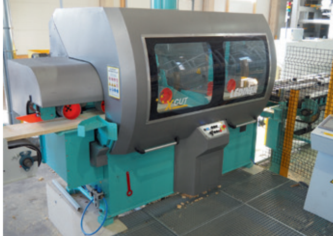
... welche die robuste X-Cut-Kappsäge von Ledinek im Anschluss auskappt
