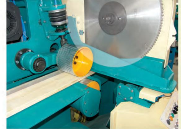
Sägenhub durch Servoantrieb vorpositionierbar von oben wirkend!
