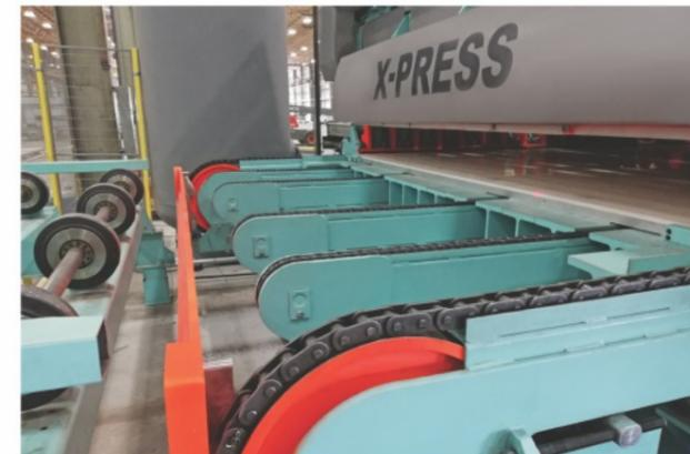
Die obere und untere Lage werden durch das letzte Druckelement und den beweglichen Anschlag festgeklemmt.
