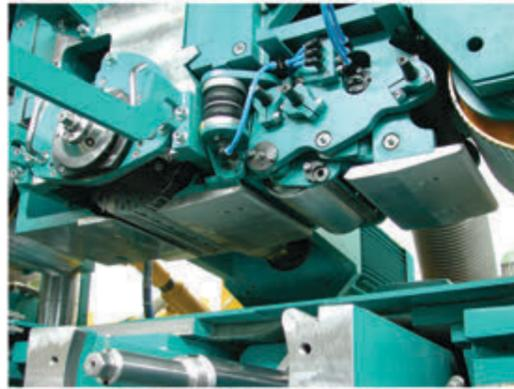
Vorschubwalzen, Arbeitsspindel und alle Druckelemente sind im kompakten Oberteil bedienerfreundlich integriert.
