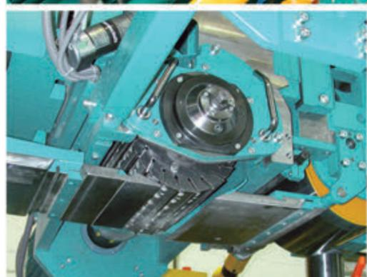
Die Arbeitsspindeln werden mittels Frequenzumformern angetrieben. Somit kann die Schnittgeschwindigkeit der jeweiligen Vorschubgeschwindigkeit und der Anzahl der Hobelmesser optimal angepasst werden.
