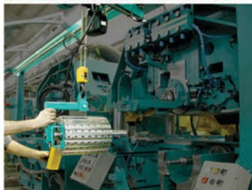
Mit dem integrierten Werkzeugkran lassen sich sowohl alle horizontalen als auch die vertikalen Spindeln erreichen. Die beigefügten Werkzeugträger ermöglichen eine sichere Handhabung.
