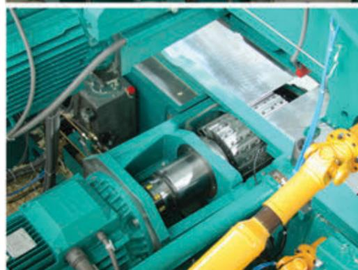
Die Spindeln werden über Direktantrieb in Rotation versetzt - ohne Riemen. Wesentlicher Vorteil des großen Spindelverstellwegs hinter die 0-Linie ist die Ausnutzung der gesamten Messerbreite ohne die Hobelköpfe zu tauschen.
