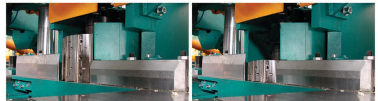
Die motorische Axialverstellung der Vertikalspindeln ermöglicht kürzeste Profilwechselzeiten.
