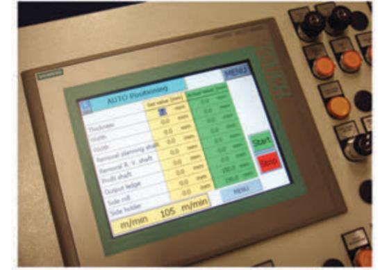
Dimensionswechsel innerhalb 1 Minute ist mit der Industrie-SPS möglich.
