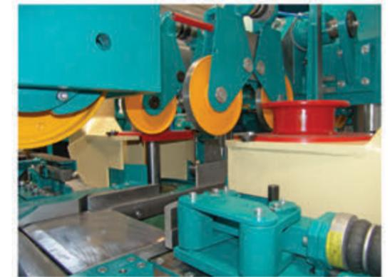
Die gegenüberliegenden Vertikalspindeln garantieren beste Maßhaltigkeit.
