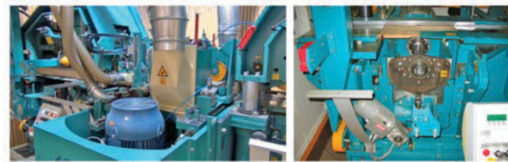
Hohe Vertikalspindeln mit Gegenlager und Faseinheiten.
