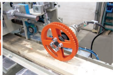
Length measuring device in front of the saw. Längenmessgerät vor der Säge.
