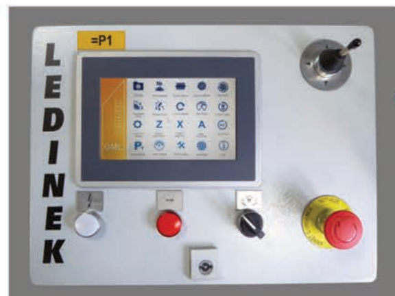
Operating console with touch screen. Bedienkonsole mit Touch screen.
