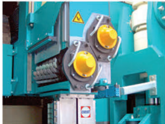
Doppelte Fräseinheit mit Hochleistungsspindeln und Gegenlagern, für Fräser bis 200 mm.
