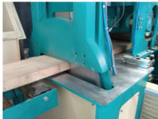
Ablängsäge mit integrierter Längenmessung für Kappung der Lamellenlängen.
