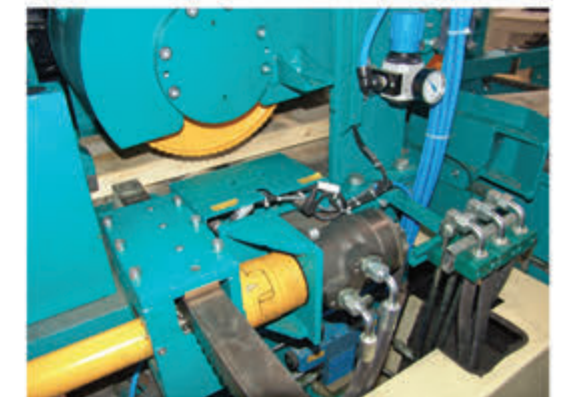
Starke hydraulische Lineale richten das Brett seitlich aus.
