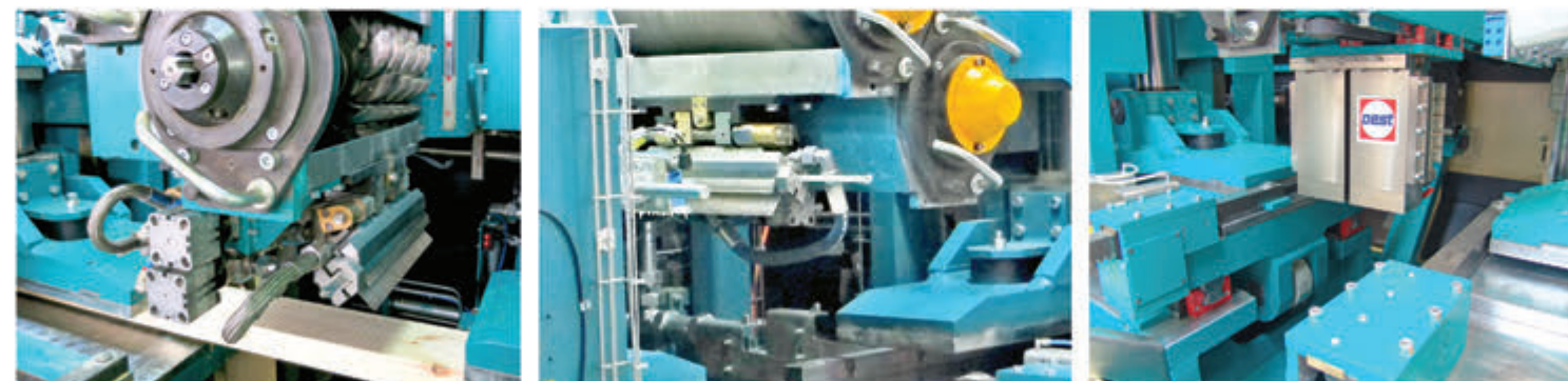
Integriertes Leimauftragsystem mit Kamm für MUF, KAS einseitig für PU oder berührungslos mit automatischer Stärkeneinstellung. Integrated glue application system with matrix for MUF, KAS for 1-side PU or contactless with automatic adjustment of thickness.
