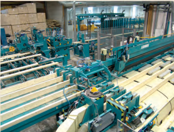
KONTIZINK Durchlaufkeilzinkenlinie für BSH Anlagen. Continuous finger jointing line for glulam plants.
