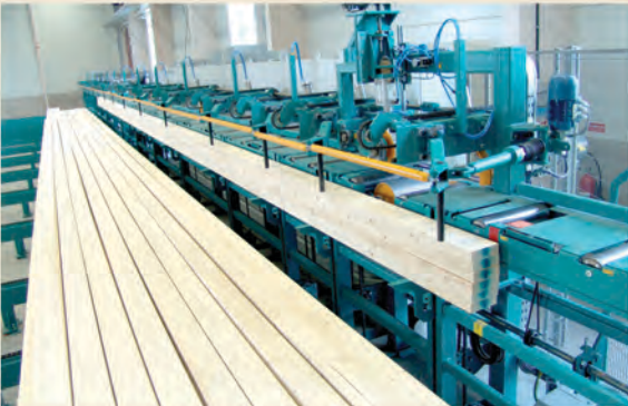
Lamellenlager zur aushärtung der Keilzinkenverbindungen. Laminations storage for curing of finger joints.
