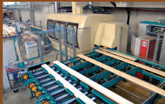
EUROZINK COMPACT Keilzinkenanlage für Produktion von KVH, Lamellenbalken und Brettschichtholz Finger jointing machine for production of solid structural timber and glulam laminations
