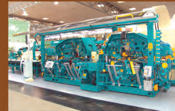
SUPERPLAN Hochleistungs-Hobelmaschine zum Profilieren, Hobeln und Spalten High performance moulding, planing and splitting machine
