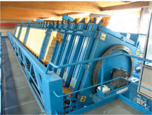
ROTOPRESS Anlage mit rotierender Presse ist zur vollautomatischen Verpressung von Duo- und Triobalken, Brettschichtholz, Blockhauselementen, Fensterkanteln, Schallungsträgern, Deckenelementen und Deckenbalken geeignet. Line with rotating press is used for fully automated pressing of Duo and Trio beams, glulam beams, elements for log buildings, laminated window scantlings, formwork beams, ceiling elements and ceiling joists.
