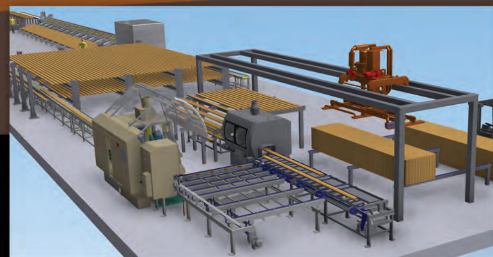
Stapelmaschine für gehobelte Balken Stacking machine for finished beams
