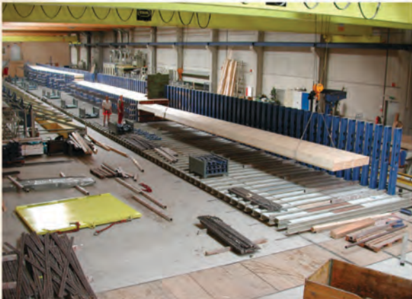
HYPERPRESS SPS gesteuerte Bogenpresse dient zur automatisierten Herstellung von gekrümmten Bauteilen aus Brettschichtholz. PLC controlled press for curved beams was developed for automated production of arched elements made of laminated timber.
