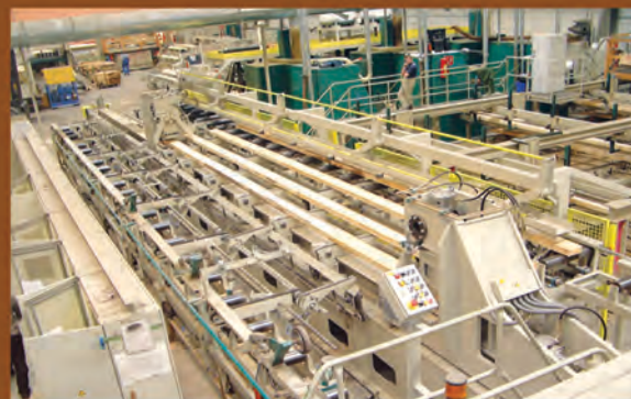
Die BEAMPROOF prüft jeden einzelnen keilgezinkten Balken auf Zugbelastung.
