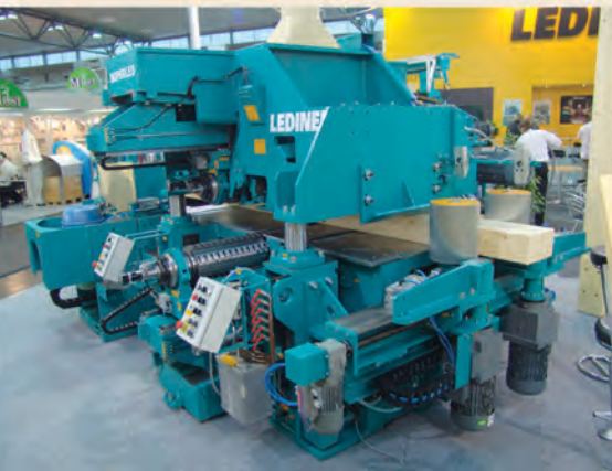
SUPERLES Vierseitige Fertighobelmaschine mit Fasen und zusätzlichen Profilierungsspindel. Four-sided planing machine with chamfering and additional profiling units.
