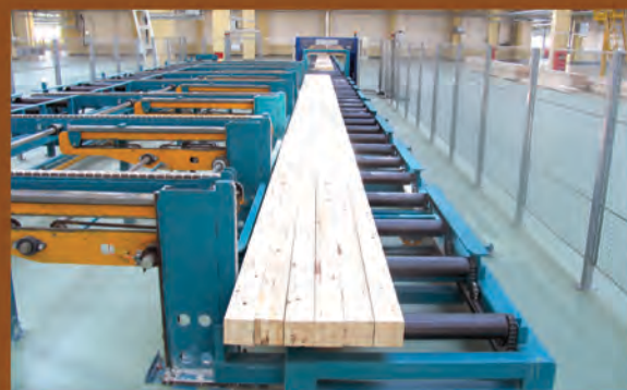
Stapelmaschine für gehobelte Balken Stacking machine for finished beams
