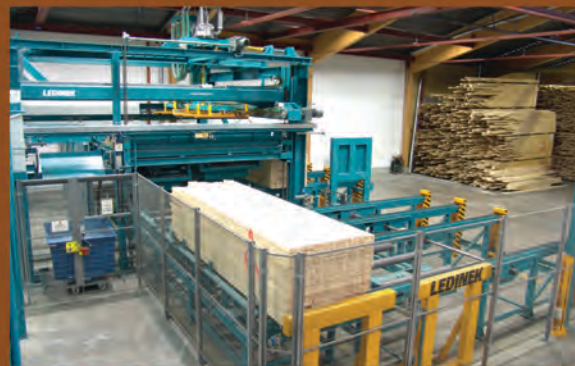
Mit der vollautomatischen Vakuumentstapelung werden die Bretter entstapelt. Fully automated vacuum unit for destacking of the boards.
