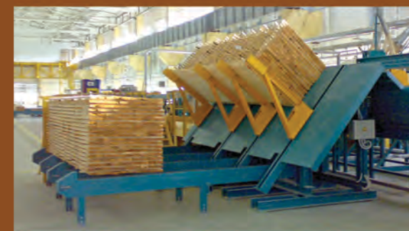
Kipptisch zur Entstapelung von Brettern Tilt table for destacking of boards
