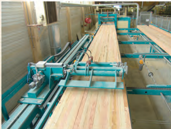
LKS Lagenkappsäge für Kommissionierung von verpressten Leimbindern. Wide crosscut saw for commissioning of pressed beams.
