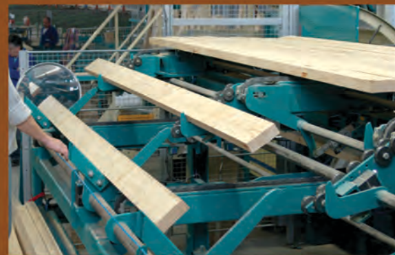
Fehlermarkierung und Gütesortierung Defect marking and quality grade sorting
