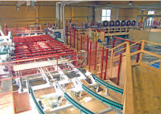
KONTIZINK H Horizontale Keilzinkenanlage für Blockhausbohlen und Lamellen für Wandelemente. Horizontal finger jointing machine for log house beams and laminations for wall panels.
