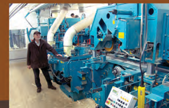
STRATOPLAN Hochgeschwindigkeitshobelmaschine für schwersten Einsatz Heavy duty high speed planer
