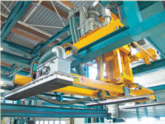
Mit der vollautomatischen Vakuumentapelung werden die Bretter entstapelt. Fully automated vacuum unit for destacking of the boards.
