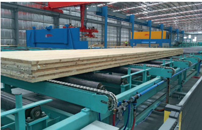
Die fertige ausgehärtete Platte liegt für den Abbund bereit
