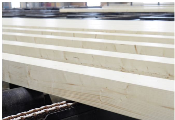
Perfekte Oberfläche: Die Finalhobelmaschinen von Ledinek sorgen für sauberes Leimholz ohne Hobelschlag
