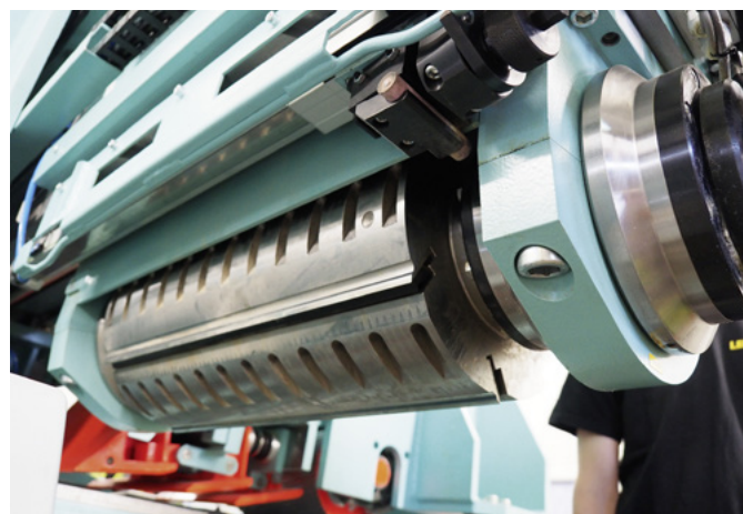
Ganz neu bei der Superles 400 ist die Jointvorrichtung: Die vollständig geschlossene Konstruktion verringert die Schmutzanfälligkeit
