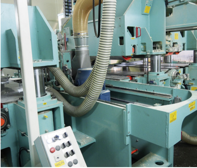
Ging im Januar 2020 in Betrieb: Die Superles 1300 bearbeitet BSH bis 1300 mm Breite...
