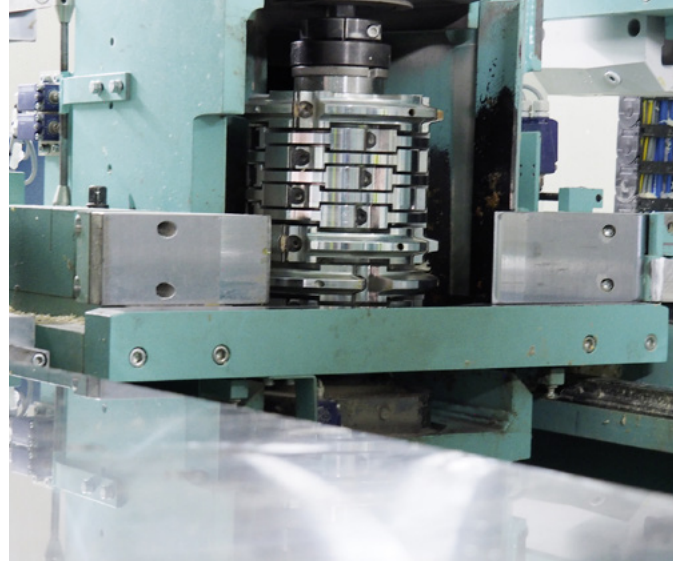
... und ist zudem mit zwei Falzeinheiten sowie acht Fasenaggregaten ausgestattet
