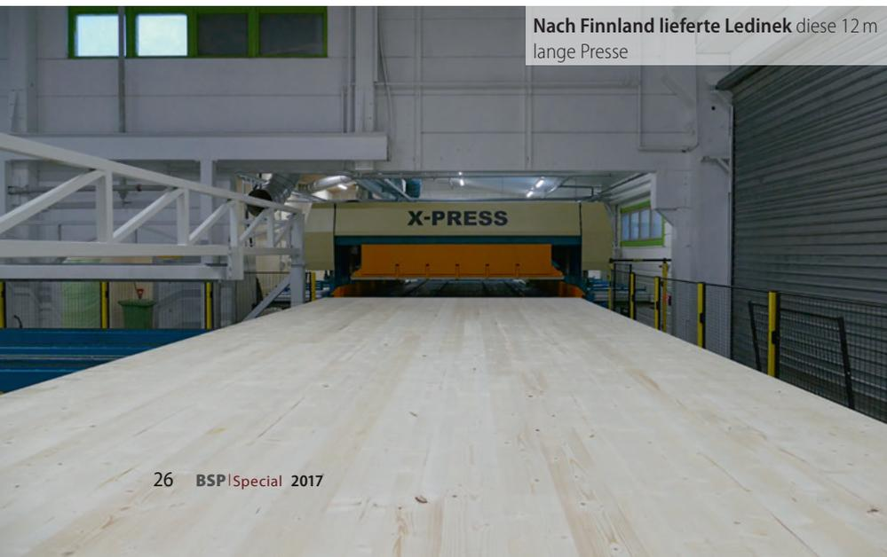
Der Seitendruck verläuft durchgehend und ist im Raster von 250 mm einzeln steuerbar
