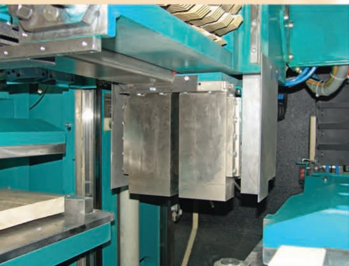
Berührungsloser Leimauftrag mit automatischer Breitereinstellung. Contactless glue applicator with automatic adjustment of width.
