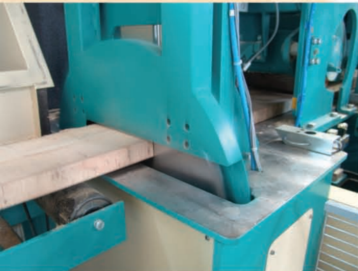
Ablängsäge mit integrierter Längenmessung für Kappung der Lamellenlängen. Crosscut saw with integrated measuring device for cutting laminations to length.
